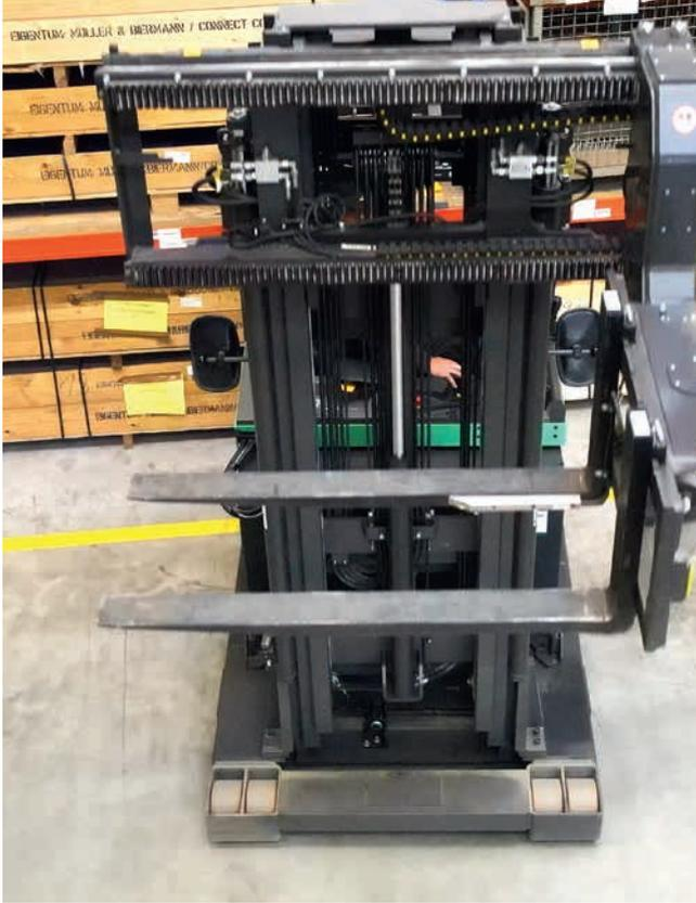
Mit dem Seitschubschwenkgerät, das nicht über die Breite des THD hinausragt, können die Paletten im Regalgang sowohl ins linke wie ins rechte Hochregal abgelegt oder entnommen werden (Bild rechts).
