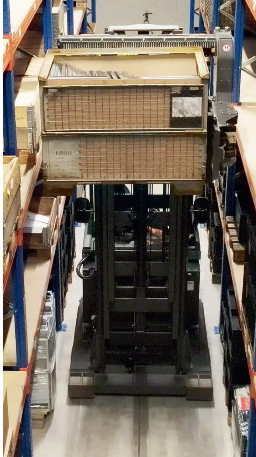
Im Gang wird der THD über einen im Boden eingelassen Draht geführt. So kann der Stapler ohne Regalberührung seine Lasten verteilen und aufnehmen.
