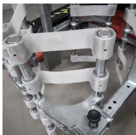
Sonder-entwickelte Greifer aus Polyurethan
