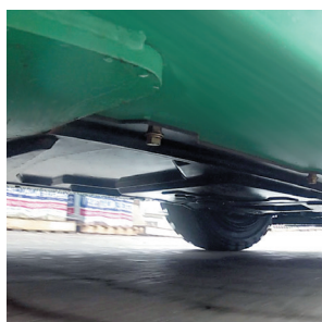
Rahmen mit Unterboden-Schutzplatte
