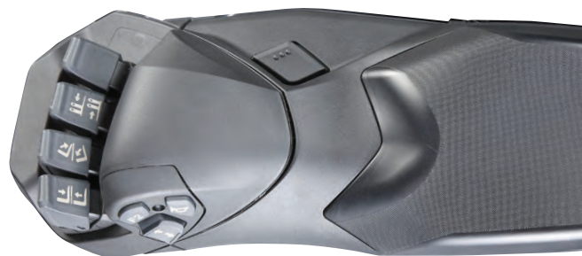
ErgoCentric: verstellbare Armlehne mit integrierter Fingertipp-Steuerung
