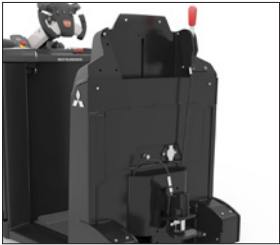
Automatische Kupplung mit ergonomischem Entriegelungsgriff
