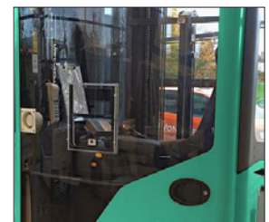
2-Wege-Sprechanlage für Kühlhauskabine (CSM)
