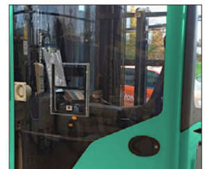
2-Wege-Sprechanlage für Kühlhauskabine (CSM)
