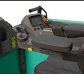
Mini-Lenkrad mit frei beweglicher Armlehne
