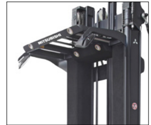
Schuttdach mit 4 LED-Spots
