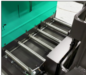
Batterie auf Stahlrollen
