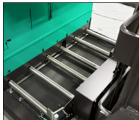
Batterie auf Stahlrollen
