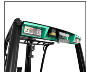
LED-Arbeitsscheinwerfer, 2 vorne und 1 hinten
