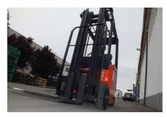
Carer Elektromotoren bieten hohe Leistung und Drehmoment. Die elektronisch gesteuerte Leistung verleiht dem Z25HD eine unerreichte Geschwindigkeit und Wendigkeit. Um die Autonomie für jeden Einsatz zu gewährleisten ist eine Reihe von verschiedenen Batterien einsetzbar. Die seitliche Batterieentnahme kann mit einem Gabelstapler oder eine Hebevorrichtung erfolgen.
