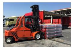
ausgestattet, der eine hohe Effizienz gewährleistet und einen geräuscharmen Betrieb, durch die hohe Präzision der Schrägverzahnung erreicht. Die Hinterachse verfügt über einen Lenksensor, der die Reduzierung der Geschwindigkeit bei Kurvenfahrten garantiert.
