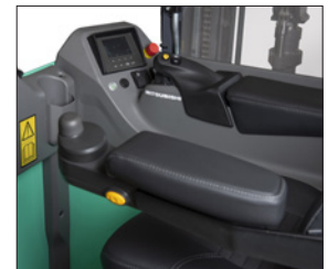
Mini-Lenkrad mit schwimmend gelagerter Armlehne
