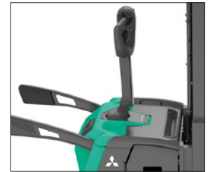
Deichselarm aus Metall mit mechanischer Lenkung
