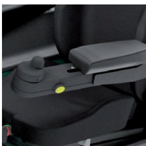
Mini-Lenkrad mit schwimmend gelagerter Armlehne
