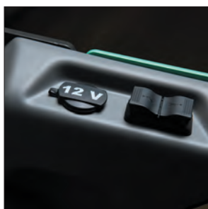
12-V-DC-Steckdose und doppelter 5-V-USB-Anschluss
