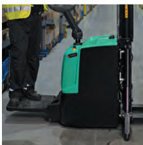
Klappbare Plattform und Seitenstabilisatoren
