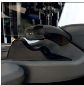
Ergonomische Lenkung mit Antriebssteuerung
