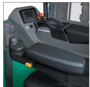
Mini-Lenkrad mit schwim- mend gelagerter Armlehne
