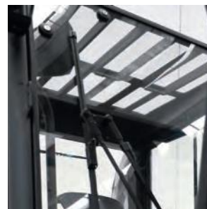
Windschutzscheibe und Dach mit Wisch-/Waschanlage
