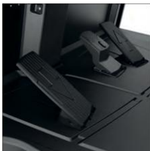
Optionales Fußpedal für Fahrtrichtung
