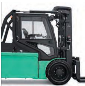
Niedriges Lastschutzgitter für Arbeiten in Containern
