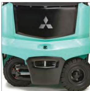
Hinterachse lenkt um mehr als 100 Grad ein
